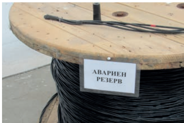
Изолирани проводници, аварийен резерв в склад на КЕЦ Хасково.
