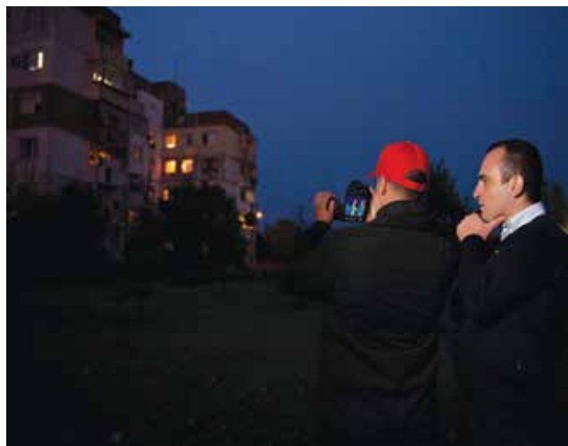
Обследването се прави чрез заснемане с термографска камера вечерно време при ниски външни температури, за да може да се получат добри инфрачервени снимки.
