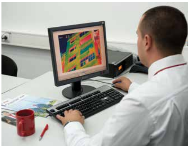
За получаването на добър термографски образ на камерата вътрешната температура на сградата трябва да е над 20° C.
